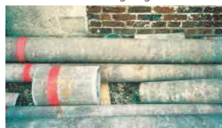
Canalisation en amiante-ciment
